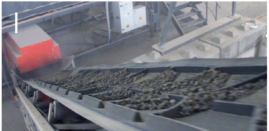
De nieuwe machine kan het beton scheiden in de oorspronkelijke grondstoffen grind, zand en cement.
